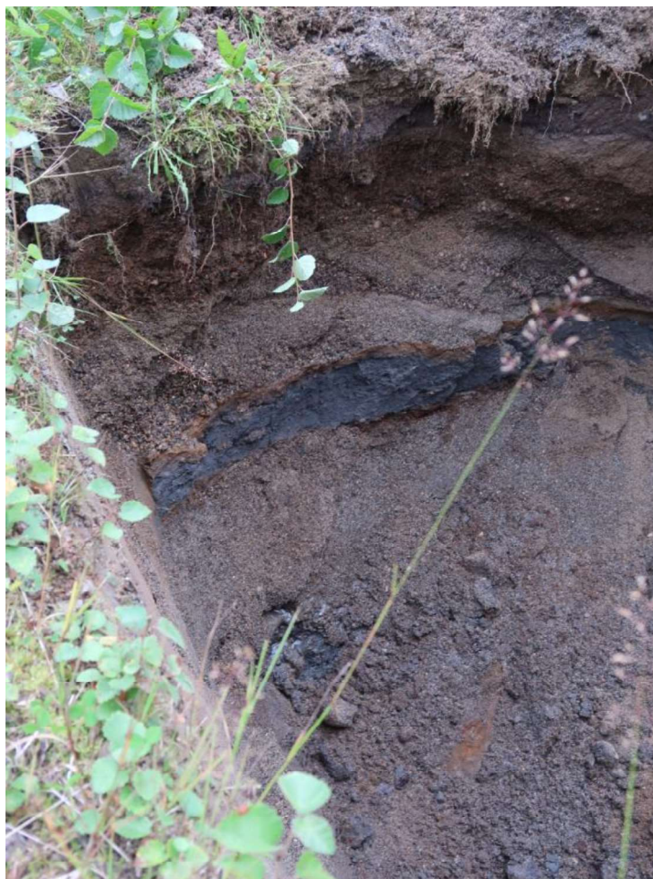
Bilde 1: Prøvehull 2 med en linse av fast sandig silt i løst lagret sand. Tykkelsen er ca 10 cm. Mer grusige masser nær toppen og i lag nedover. Grunnvannet er begynt å pipe frem i hullet, kom noe langsommere enn i hull 1.
