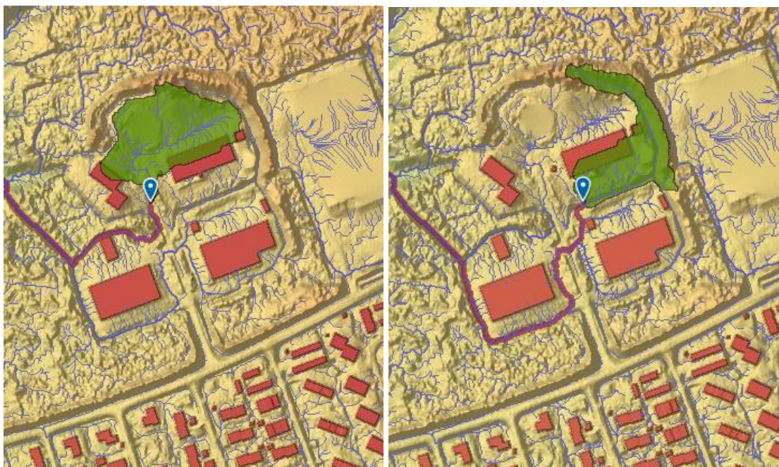
Figur 4-1. Avrenningsanalyse over planområdet for eksisterende situasjon, med flomveier oppå bakken t.v. og grøft t.h. Kilde: Scalgo.
