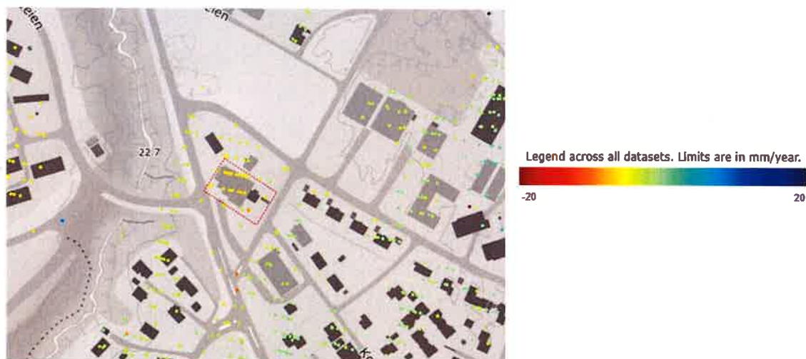
Figur 10 Utklipp fra insar.ngu.no. Satellittmålinger fra 2014 til i 2021. Plassering av Exim-bygg er omtrentlig markert med stipulert rød boks.
